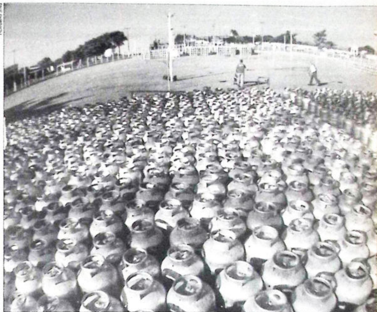
Botijões com gás mal acondicionado, em recipientes velhos e enferrujados, podem oferecer grandes riscos de explosões
