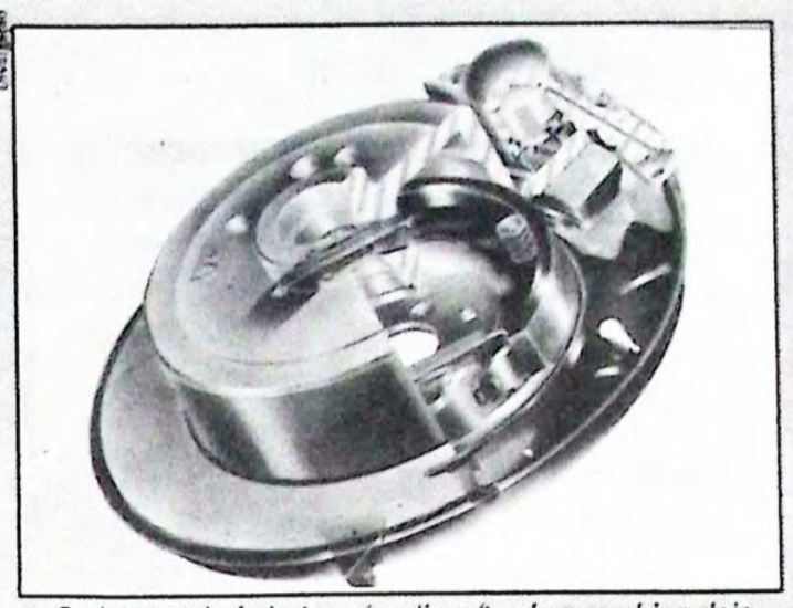
O sistema de freio traseiro disco/tambor combina dois freios independentes em uma só unidade. O cavalete fixo atua como freio a disco de serviço, ao passo que o freio a tambor tipo "duo-servo", é utilizado para estacionamento.
